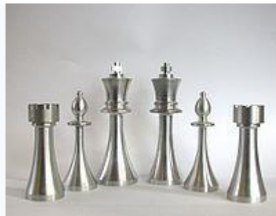
Piezas de ajedrez mecanizadas en un torno CNC.
